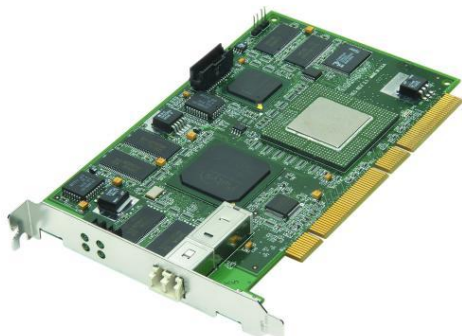
iSCSI-Adapter: Adaptec liefert mit dem ASA-7211 einen 1-Gbit-iSCSI-Adapter mit TCP-Offload auf dem ASIC. (Quelle: Adaptec)
